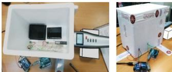
Figura 2. Sperimentazione in laboratorio: sistema proposto e termogigrometro di riferimento.
